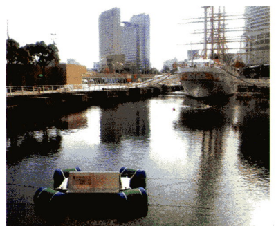
超微細気泡を発生させて水質を浄化する装置（横浜みなとみらいでのテスト）
